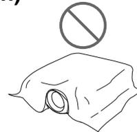
No cubra los orificios de ventilación frontales, ya que en caso contrario puede producirse recalentamiento interno.
