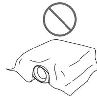
Ne couvrez pas les orifices de ventilation; sinon, la chaleur risque de s'accumuler à l'intérieur.
